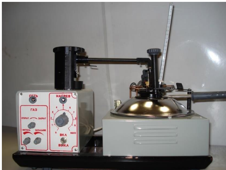
Рис. 2.1. Аппарат для определения температуры вспышки «Закрытый тигель» 1- блок управления; 2- двигатель с приводом мешалки; 3- тигель; 4- термоблок.
